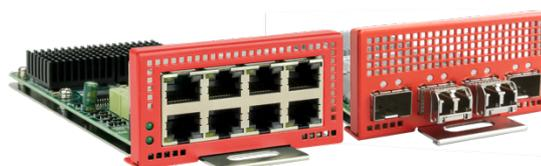
Diese UTM-Firewall der Enterprise-Klasse verfügt auf der Vorderseite über zwei Einschübe, um Erweiterungskarten aufnehmen zu können. Zur Auswahl stehen Karten mit **8-Port 1 GBit/s Ethernet (RJ-45)** und **4-Port GBIC für SFP+ 10 GBit/s Module (SR oder LR)**.
